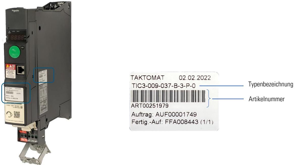
Abb. 4 Beispiel Typenschild TIC3-075-150-B-3-0-0
