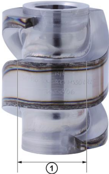
Figura: Detalhe da inclinação do Came
